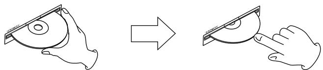
1. 図のようにレーベル面を上にしてディスクの側面を持って、途中までディスクを挿入してください。
